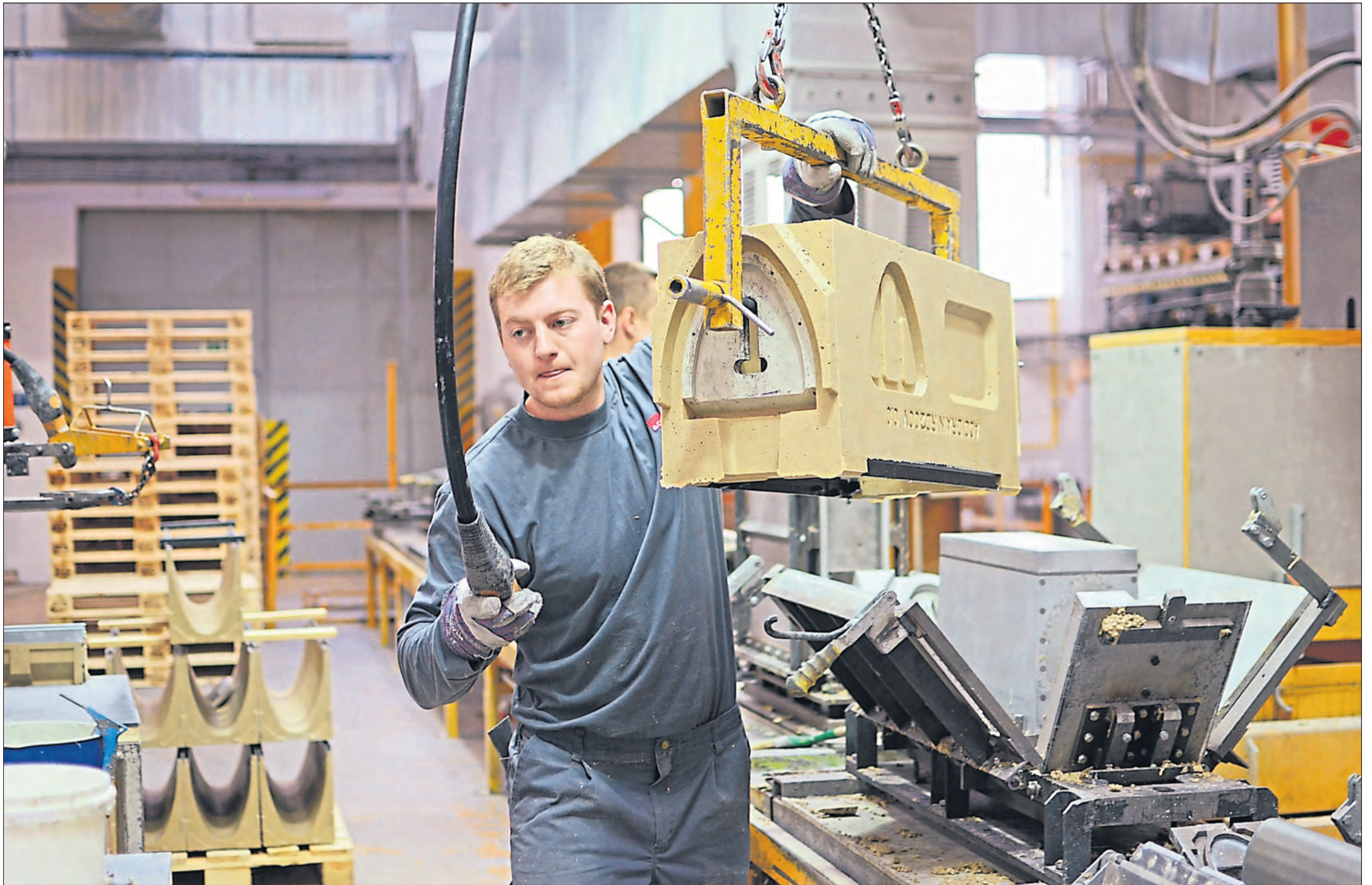
Entwässerungsrinnen für den globalen Markt: Im Werk Büdelsdorf entstehen die Elemente, die nicht zuletzt bei Starkregen für Entlastung sorgen.
